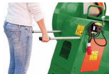
Timons rétractables avec roulettes pour déplacement manuel
